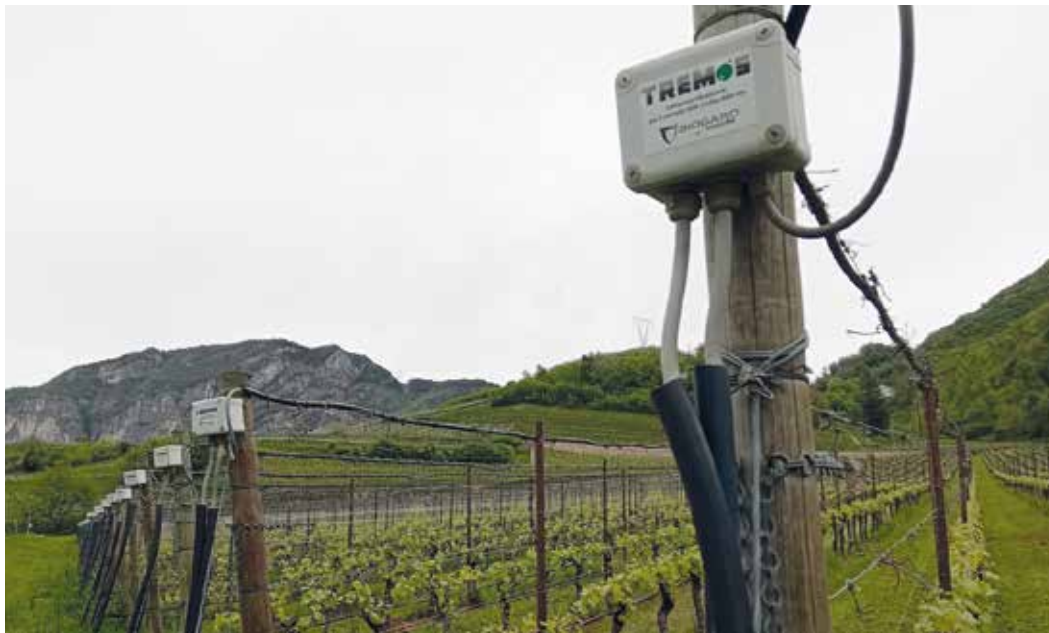
Na končnih kolih pritrjeni vibratorji kot del poskusa tretiranja proti ameriškemu škrtatku
